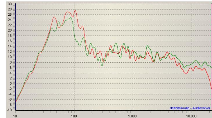
Abbildung 3: Amplitudenfrequenzgang Original: Rot = Linker Kanal, Grün= Rechter Kanal
