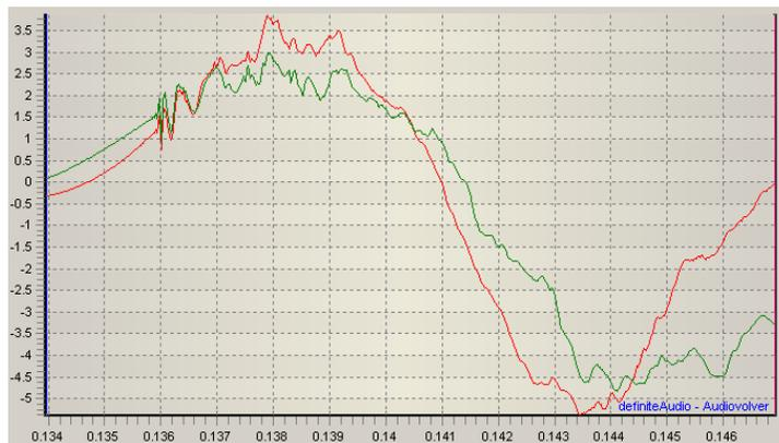
Abbildung 6: Sprungantwort Original 10ms: Rot = Linker Kanal, Grün= Rechter Kanal
