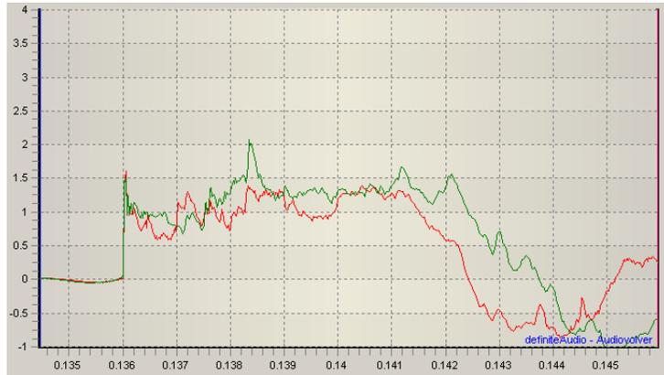
Abbildung 15: Sprungantwort mit Optimizer 10ms: Rot = Linker Kanal, Grün = Rechter Kanal
