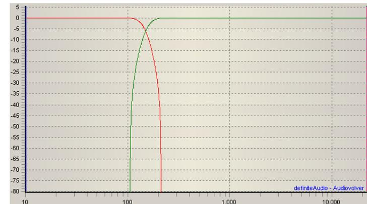
Abbildung 2: Amplitudengang der Neville Thiele Frequenzweiche im AudioVolver
