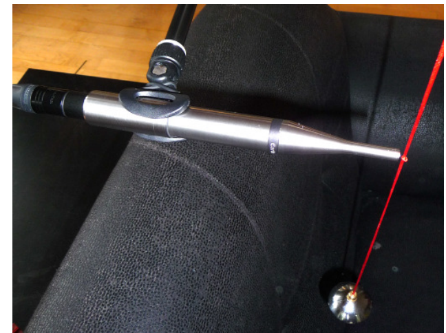
Abbildung 2: Senklot am Hörplatz mit dem Referenzmikrofon M30BX
